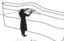
peg + strip renforce la connexion entre couches de softblocks superposés
